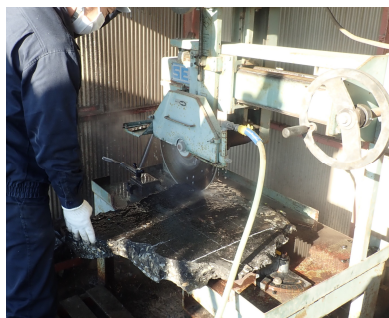
供試体切出し状況
