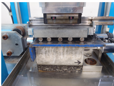
コンクリート/アスファルトマット アスファルトマット/碎石 写真-B.9 摩擦試験状況
