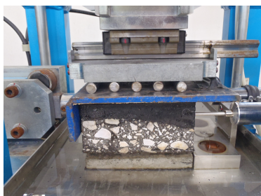
コンクリート/アスファルトマット アスファルトマット/碎石 写真-B.9 摩擦試験状況
