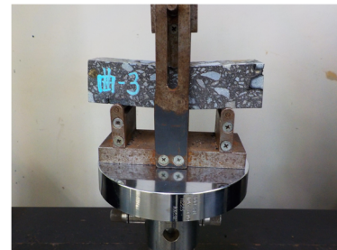
写真-B.3 曲げ試験状況
