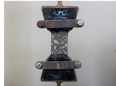
写真-B.6 引張試験状況
