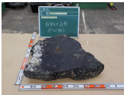
採取した試料（ケーソン側）
