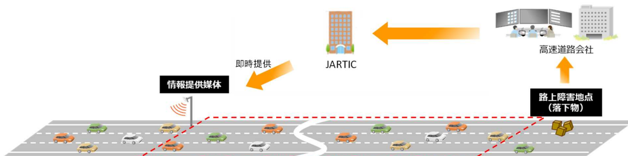
図 4-3 情報提供開始時点で情報提供媒体を通過して情報を受けられない車両
