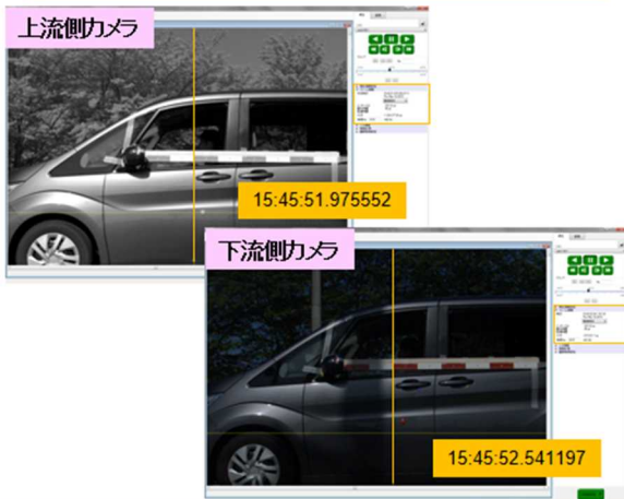
2台のカメラの通過時刻差(12m): 区間速度
