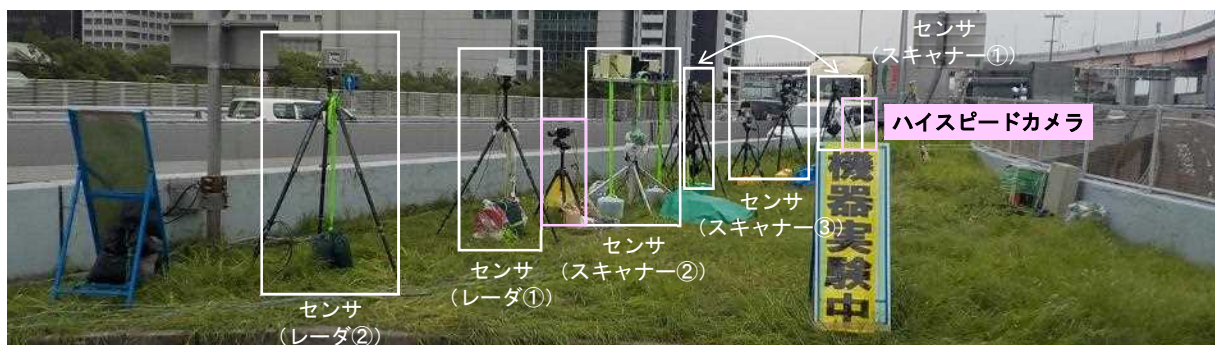
図 4-4 実験時の機器配置レイアウト
