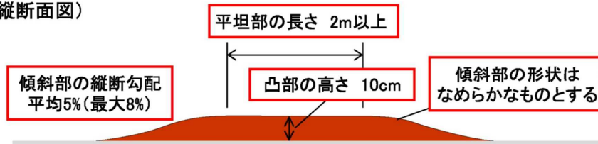
図1 技術基準で規定されるハンプの構造
