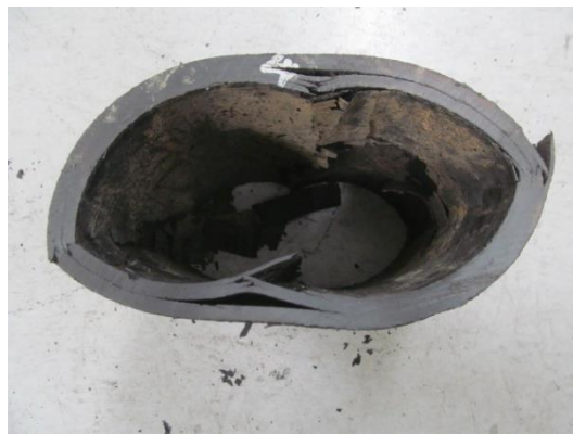
写真Ⅲ-6 供試体 No. 6（左：偏平試験前、右：偏平試験後）
