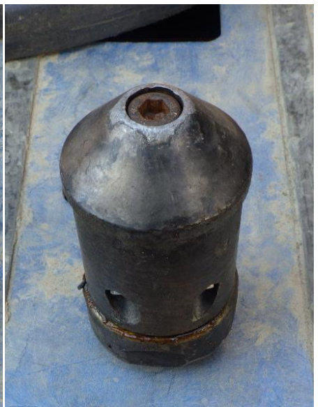
写真 3. 3-2 高圧洗浄試験に使用した洗浄ノズル (左：後方噴射ノズル、中：前方噴射ノズル、右：旋回ノズル)
