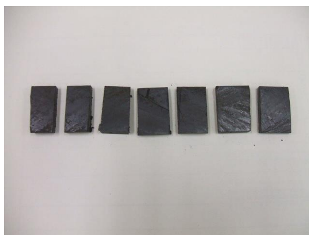
写真Ⅱ-4 約3cm 2 に分割した試験片
