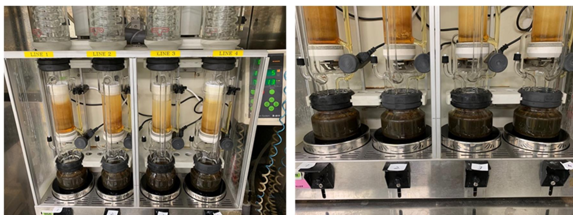
写真 3. 2-22 ソックスレー抽出の状況
