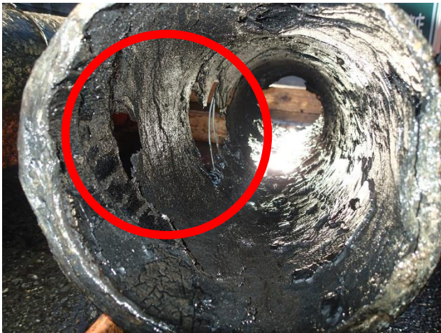
旋回ノズル後（赤丸部：穴が開いた部分）
