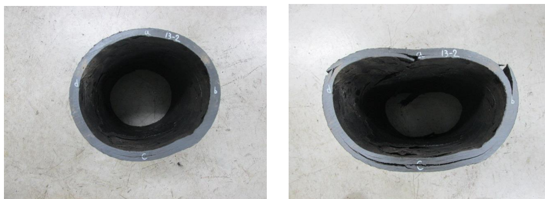
写真Ⅲ-29 供試体 No. 29（左：偏平試験前、右：偏平試験後）
