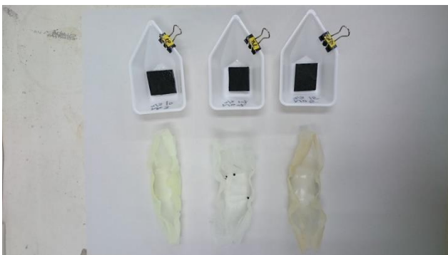
写真Ⅱ-21 試験開始 3 か月後 (40°C前後の試験溶液 : ケース C、ケース D、ケース E)
