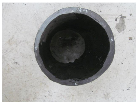
写真Ⅲ-33 供試体 No. 33（左：偏平試験前、右：偏平試験後）
