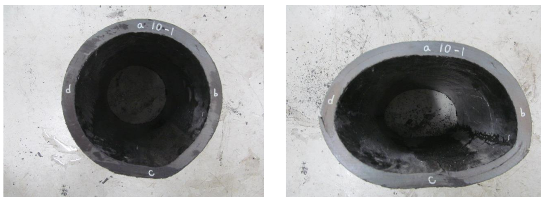
写真Ⅲ-24 供試体 No. 24（左：偏平試験前、右：偏平試験後）
