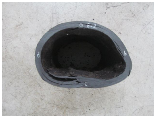
写真Ⅲ-21 供試体 No. 21（左：偏平試験前、右：偏平試験後）
