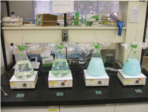
写真 II-7 洗剤水溶液浸漬試験の終了状況 (左から①～④)
