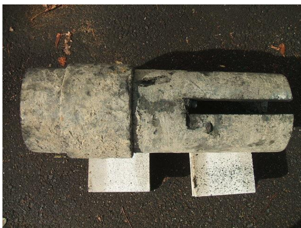
写真Ⅱ-1 布設されていた硬質瀝青管
