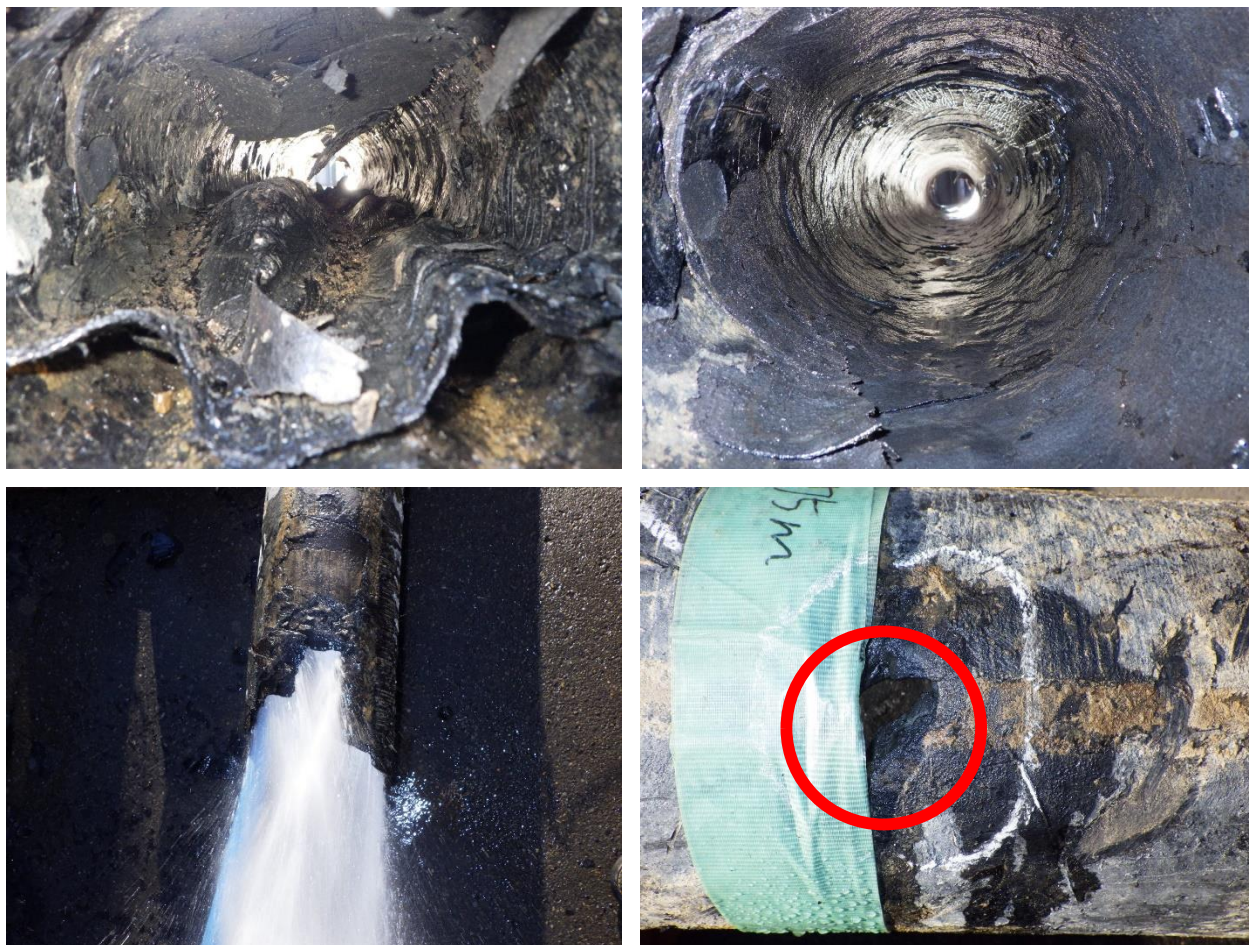
写真 3.3-4 波打ちの程度「小」の高圧洗浄試験の状況（旋回ノズル使用、洗浄時の圧力 20MPa） （左上：洗浄前、右上：洗浄後、左下：洗浄状況、右下：洗浄中に穴が開いた部分（赤丸部））
