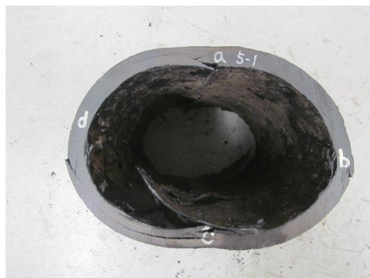
写真Ⅲ-15 供試体 No. 15（左：偏平試験前、右：偏平試験後）
