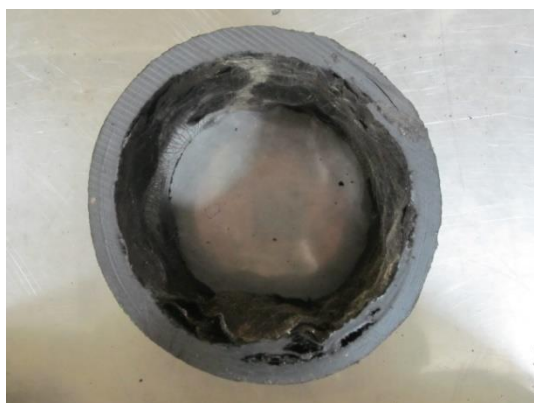
写真Ⅲ-7 供試体 No. 7（左：偏平試験前、右：偏平試験後）
