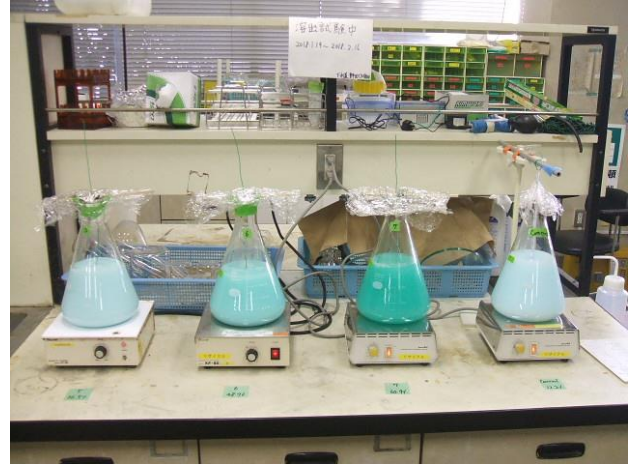
写真 II-8 洗剤水溶液浸漬試験の終了状況 (左から⑤～⑦、Control)
