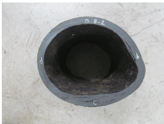
写真Ⅲ-21 供試体 No. 21（左：偏平試験前、右：偏平試験後）
