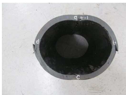
写真Ⅲ-14 供試体 No. 14（左：偏平試験前、右：偏平試験後）
