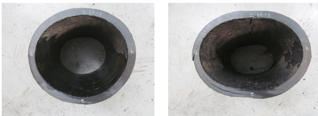
写真Ⅲ-30 供試体 No. 30（左：偏平試験前、右：偏平試験後）
