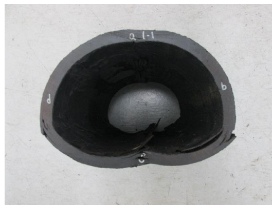
写真Ⅲ-9 供試体 No. 9（左：偏平試験前、右：偏平試験後）
