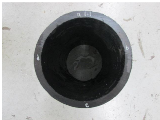
写真Ⅲ-9 供試体 No. 9（左：偏平試験前、右：偏平試験後）
