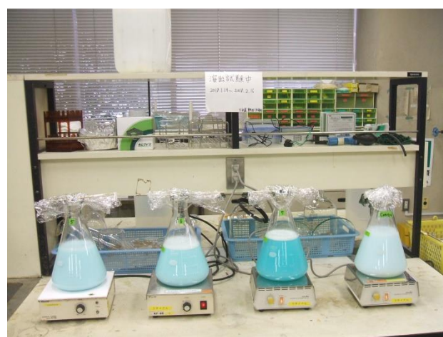
写真Ⅱ-6 洗剤水溶液浸漬試験の開始状況 (左から⑤～⑦、Control)
