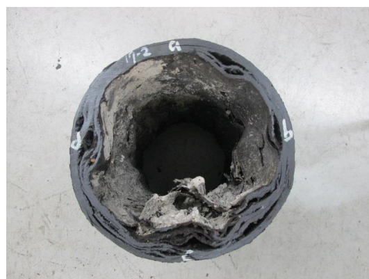
写真Ⅲ-35 供試体 No. 35（左：偏平試験前、右：偏平試験後）
