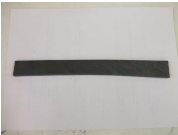
写真Ⅱ-11 切り出し部分の中間層のみを採取
