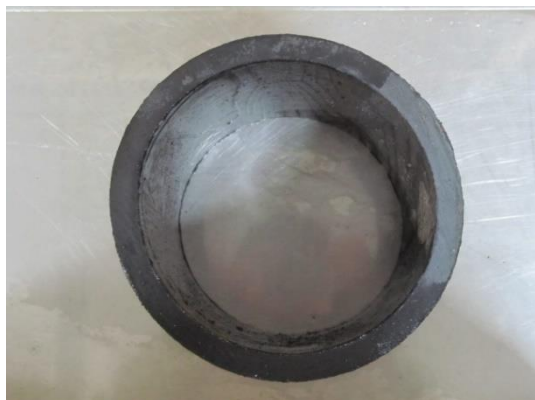
写真Ⅲ-6 供試体 No. 6（左：偏平試験前、右：偏平試験後）
