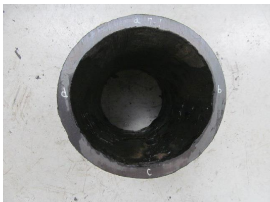
写真Ⅲ-18 供試体 No. 18（左：偏平試験前、右：偏平試験後）
