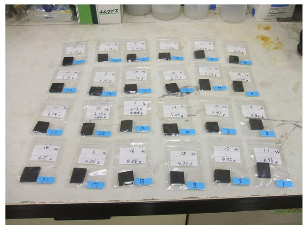
写真Ⅱ-12 3cm×3cm程度に分割した試験片
