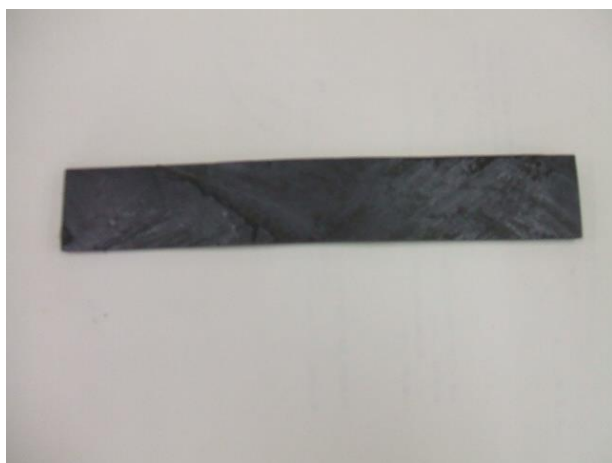
写真Ⅱ-3 切り出し部分の中間層のみを採取
