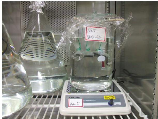
写真Ⅱ-15 40°C前後における長期間浸漬試験の開始状況 (左上：洗剤濃度 0.1%、右上：洗剤濃度 1.2%、下：温水)
