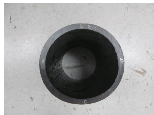
写真Ⅲ-11 供試体 No. 11（左：偏平試験前、右：偏平試験後）
