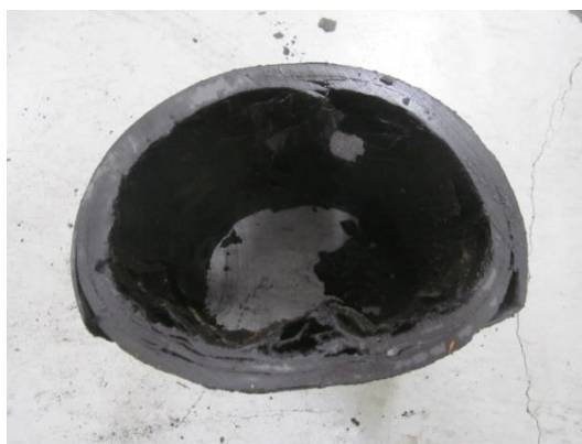
写真Ⅲ-8 供試体 No. 8（左：偏平試験前、右：偏平試験後）
