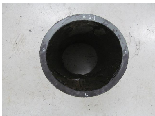
写真Ⅲ-16 供試体 No. 16（左：偏平試験前、右：偏平試験後）
