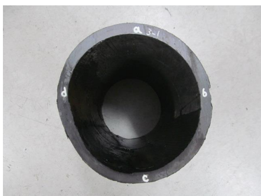
写真Ⅲ-13 供試体 No. 13（左：偏平試験前、右：偏平試験後）
