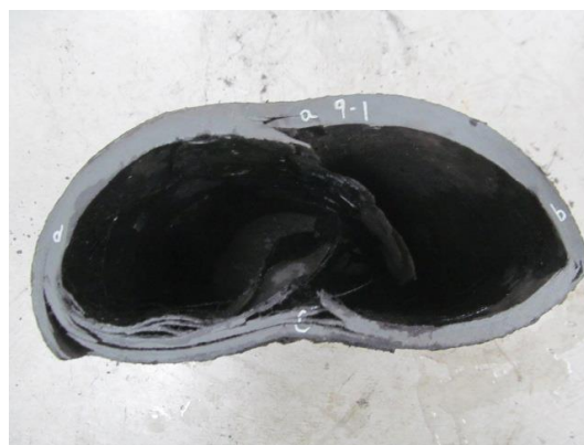
写真Ⅲ-22 供試体 No. 22（左：偏平試験前、右：偏平試験後）
