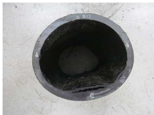
写真Ⅲ-20 供試体 No. 20（左：偏平試験前、右：偏平試験後）
