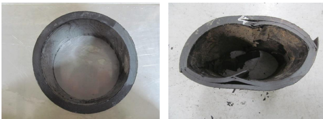
写真Ⅲ-5 供試体 No. 5（左：偏平試験前、右：偏平試験後）
