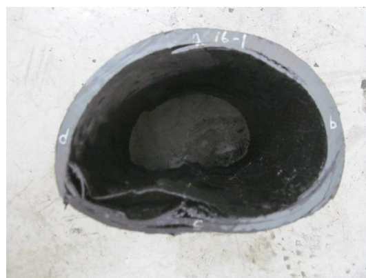
写真Ⅲ-33 供試体 No. 33（左：偏平試験前、右：偏平試験後）
