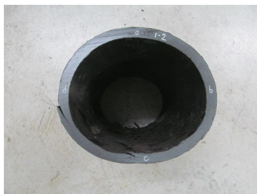
写真Ⅲ-10 供試体 No. 10（左：偏平試験前、右：偏平試験後）
