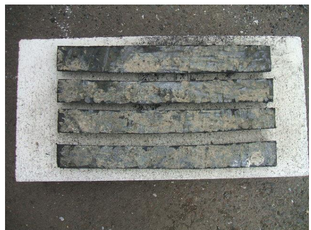
写真Ⅱ-10 硬質瀝青管の切り出し部分
