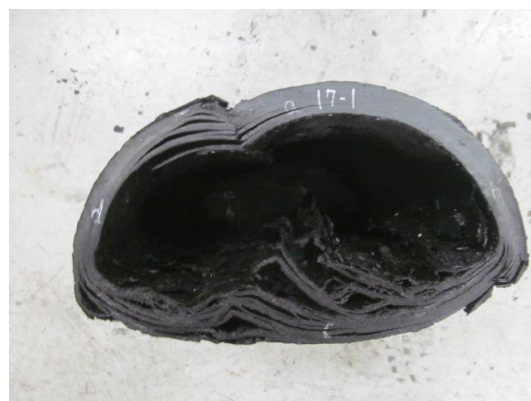
写真Ⅲ-34 供試体 No. 34（左：偏平試験前、右：偏平試験後）
