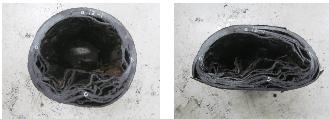
写真Ⅲ-27 供試体 No. 27（左：偏平試験前、右：偏平試験後）
