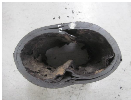
写真Ⅲ-7 供試体 No. 7（左：偏平試験前、右：偏平試験後）
