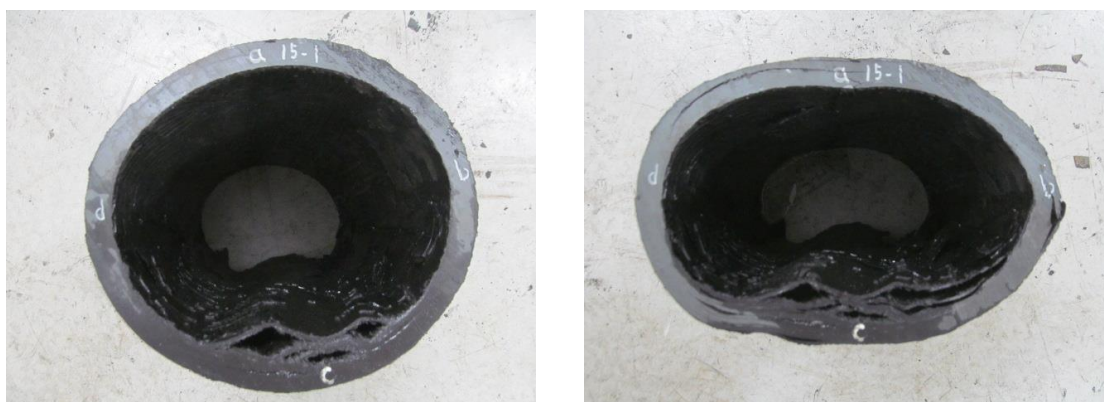
写真Ⅲ-32 供試体 No. 32（左：偏平試験前、右：偏平試験後）
