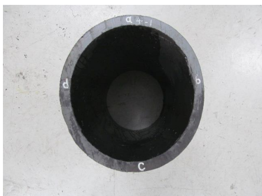
写真Ⅲ-14 供試体 No. 14（左：偏平試験前、右：偏平試験後）
