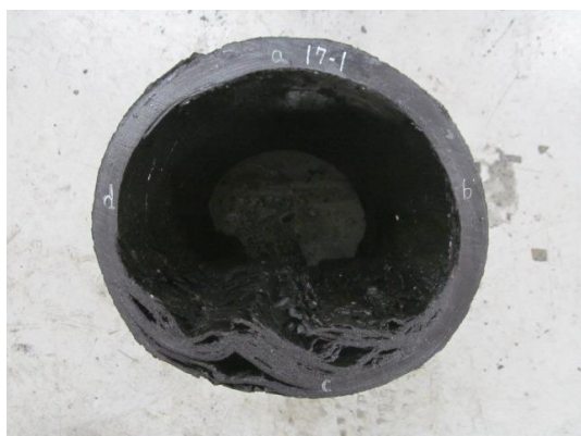
写真Ⅲ-34 供試体 No. 34（左：偏平試験前、右：偏平試験後）
