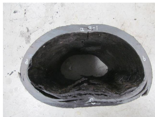
写真Ⅲ-20 供試体 No. 20（左：偏平試験前、右：偏平試験後）
