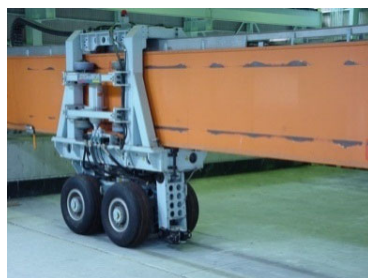
航空機荷重載荷装置
