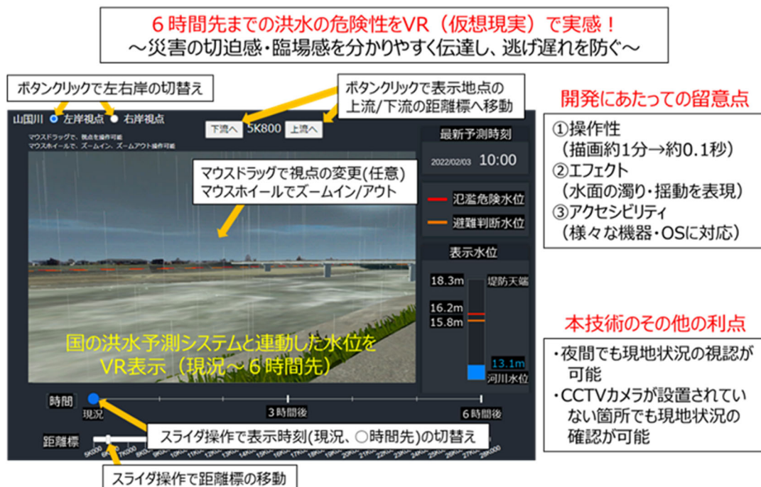
図 3-10-4 VR技術を用いた河川水位予測情報の三次元標示の例
