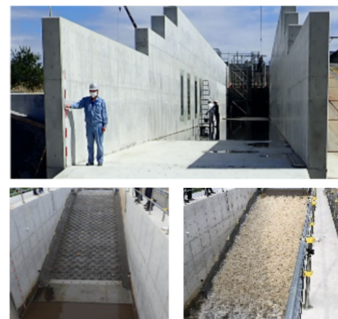
図 3-20-4 大規模堤防模型実験水路
