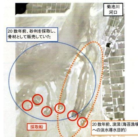
図-3.7 河口沖の砂利採取状況
