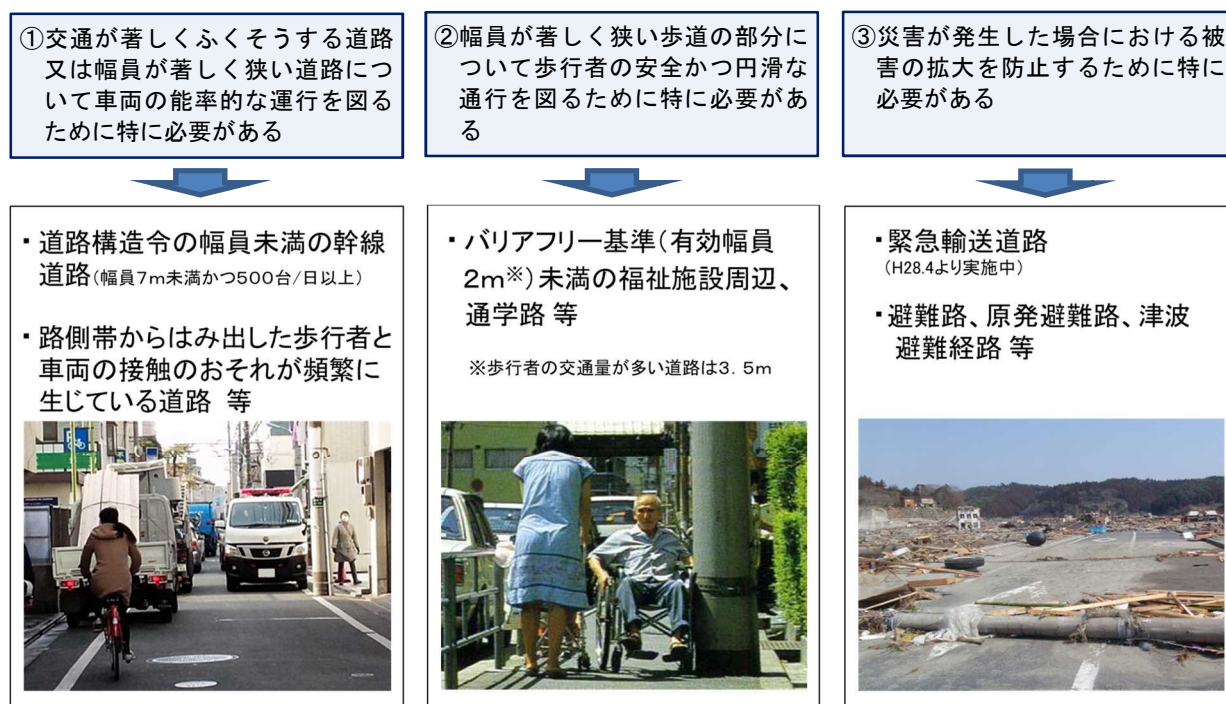
図 1 電柱による占有を禁止することが望ましい道路
