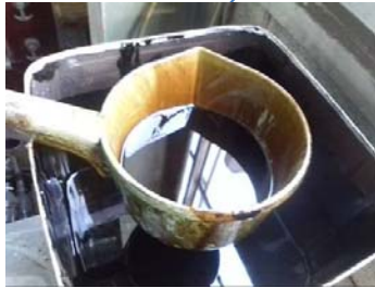
粘度の低い状態のタール(バイオオイル)を回収
