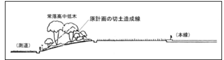
地形が小山状に残る切土法面の切飛ばし造成
