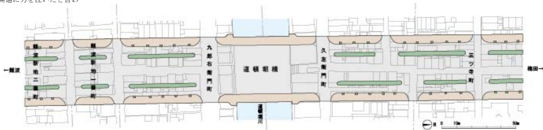
道頓堀川付近の拡張図面 旧御堂筋と比較して大きく幅員が広がっており、相当数の立ち退きが発生したことが見てとれる。
