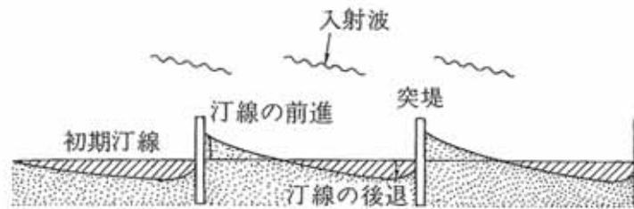
■突堤工法による海浜の安定化（出典5-1）
