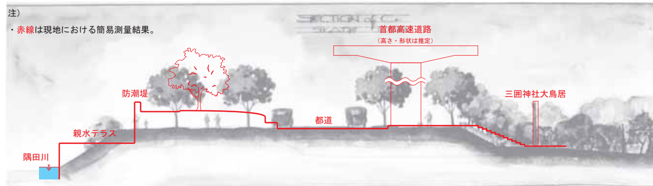
■当時の計画断面と現在の断面の重ね図(墨田区側・三囲神社地先、出典18-13)
