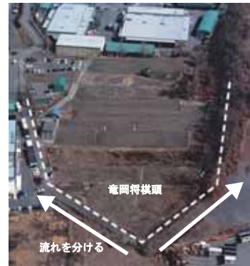
■竜岡将棋頭(C地点) (左上、出典1-7) 現状では草に埋もれている(高さ約4.3m)。 (左下、出典1-8) 流れを分けてエネルギーを分散させる。
