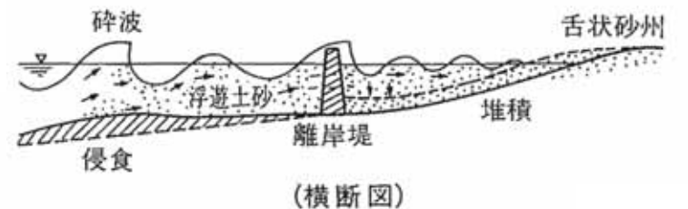
■離岸堤工法の例（出典5-4）
