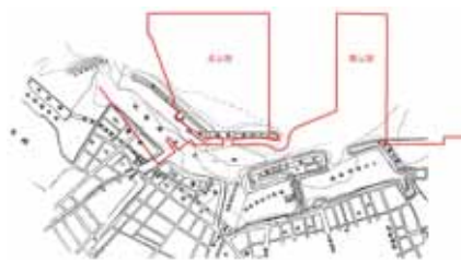
■明治の大改修時と現在の法線(出典6-9) 新波止は、港内側に腹付されていない区間が、戦後に撤去されている。
