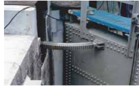
■船頭平閘門で使用されている円弧駆動ギア(出典13-6)
