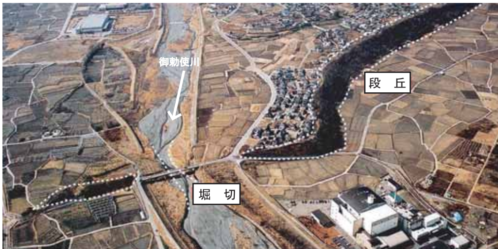
■堀切 (D地点、出典1-10) 段丘の一部を掘削して、御勅使川と釜無川の合流部が高岩周辺になるように河道の安定を図った。
