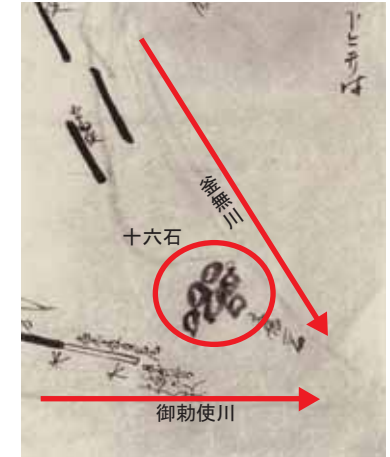
■十六石 (E地点、出典1-9) 合流部の流れを調整するために1m×2m程度の巨石が並べられたとされる。 (「下条南割村周辺堤防絵図面」、部分、山梨県立博物館所蔵)
