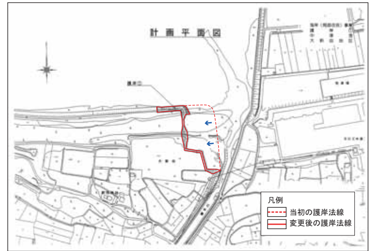
■中津港海岸におけるセットバック方式による海岸防護 (出典7-8)
