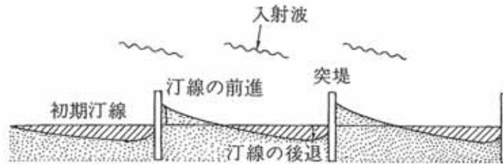
■突堤工法による海浜の安定化（出典5-1）
