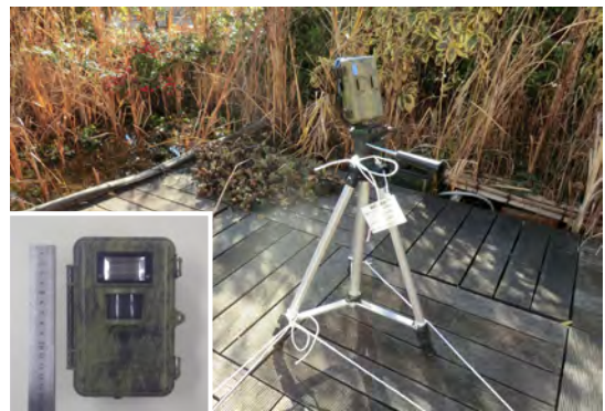
写真-2 鳥類調査用センサーカメラ設置状況
