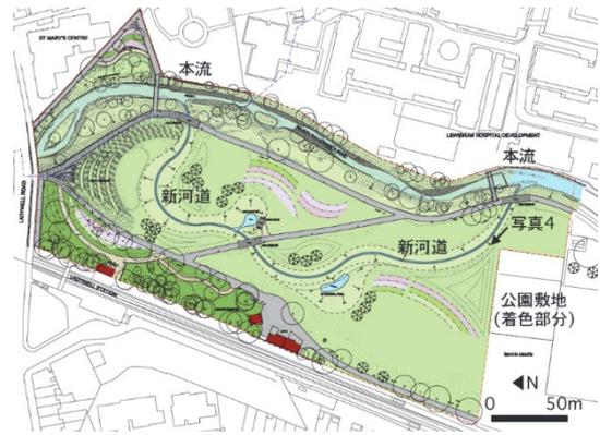
図-1 英国における洪水リスク緩和に資するGIの整備例（公園での河川の分流）（出典：木下ら（2017）<sup>1)</sup>）
