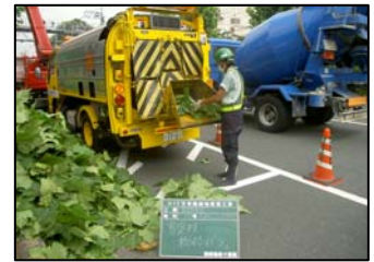
写真-4 剪定枝葉のチップ化 状況（例）
