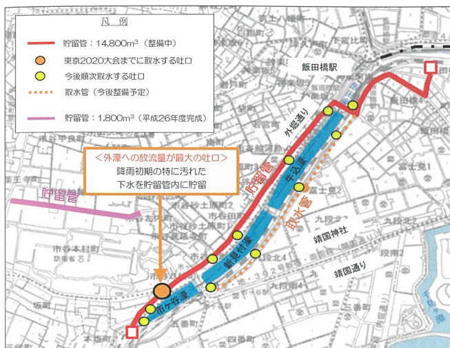
図-4 外濠の合流改善対策施設の整備
