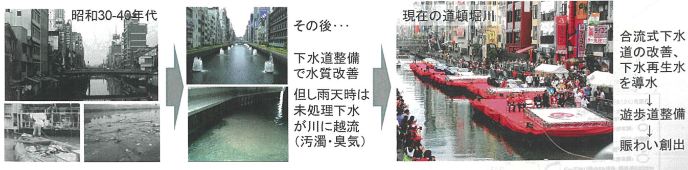
図-1 道頓堀の復活と賑わいの創出（大阪市）
