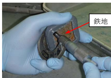
写真 2-2 管厚測定の様子
