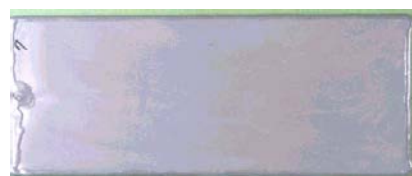
写真 4-2 耐酸性試験後の供試体の状況
