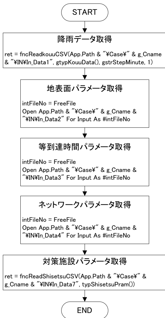
図 6-1-2 サブルーチン (Sub_ParaData_Set1 : パラメータ入力 1)
