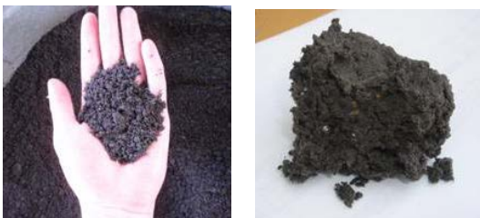
本技術の脱水汚泥(左)と従来脱水汚泥(右)
