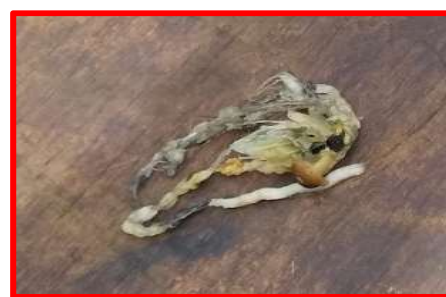
エアロック: 空気孔のし渣詰まり
