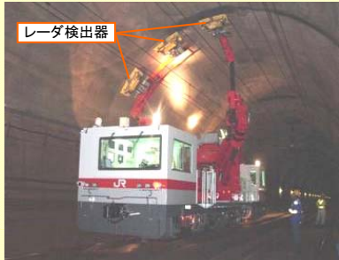
検査車による計測作業(写真は試験走行)
