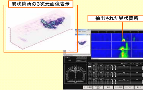
覆工内部の3次元画像表示により詳細に解析
