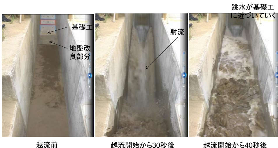
図-26 越流時の状況（越流水深 2m，地盤改良有り）
