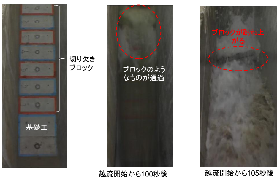
図-25 越流時の状況（越流水深 2m，地盤改良無し）
