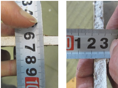
(g) せっこうボード 天井 (厚さ 8mm)、壁 (厚さ 9mm)
