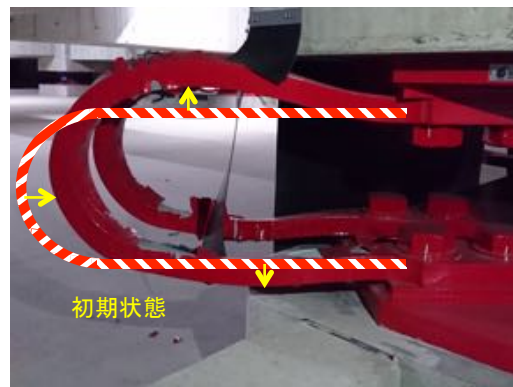
写真 5.2.2 鋼材部分の残留変形と塗装のはがれ
