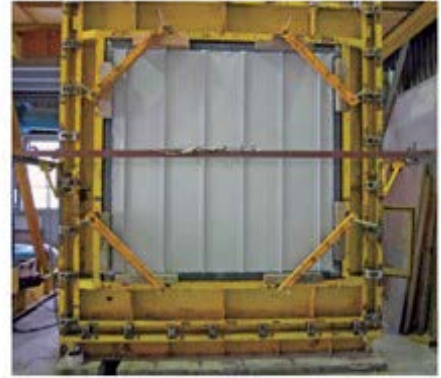
b. 圧力箱を用いた耐風圧性試験
