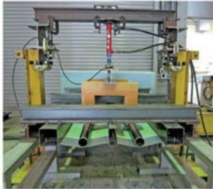
a. 鋼管を用いた線荷重載荷試験
