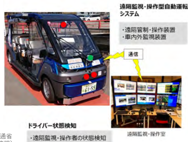
主な自動運行装置の構成
