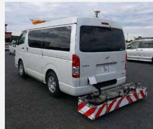
空洞化検査実施車両
