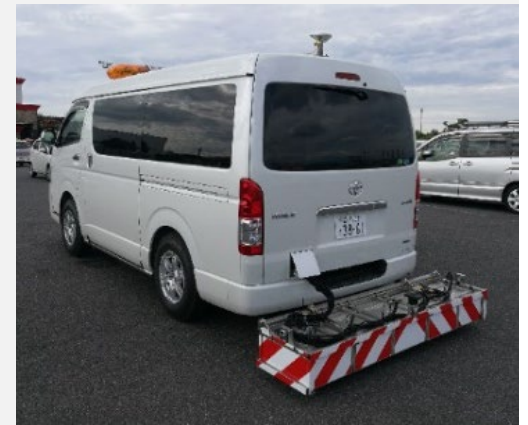
空洞化検査実施車両
