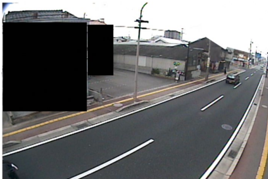
プライバシーマスクの例 個人情報の保護 肖像権やプライバシーへの配慮
