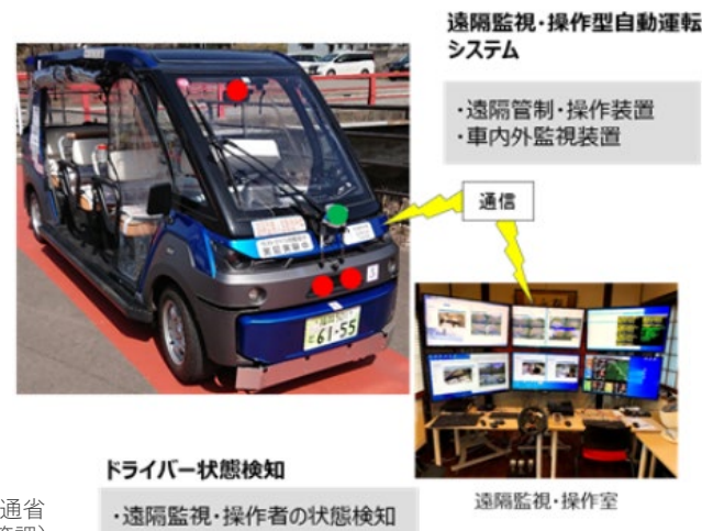
主な自動運行装置の構成
