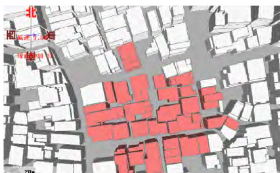
図 2-4-8 市街地火災シミュレーション 結果の表示 (簡易モード・燃烧建物表示)
