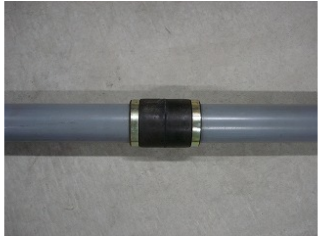
写真3 逆止弁管拡大（逆止弁状況）
