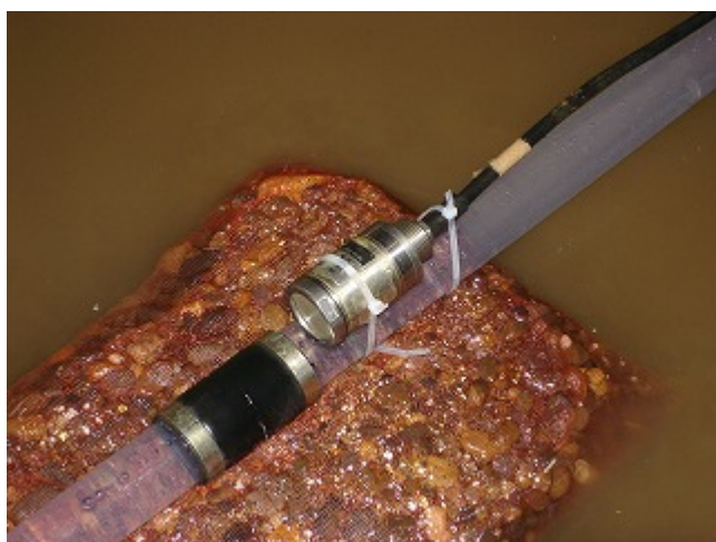
写真18 逆止弁吐出圧水圧計
