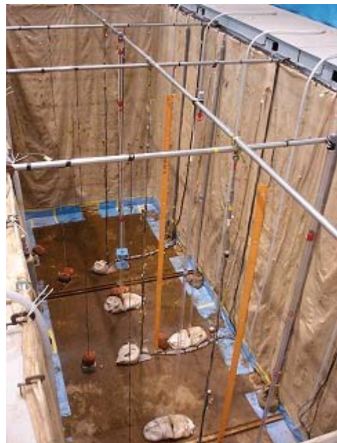
写真 2 3 地盤内計測設置全景
