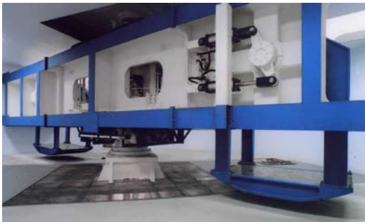
図6 実験装置(遠心力载荷試験装置)
