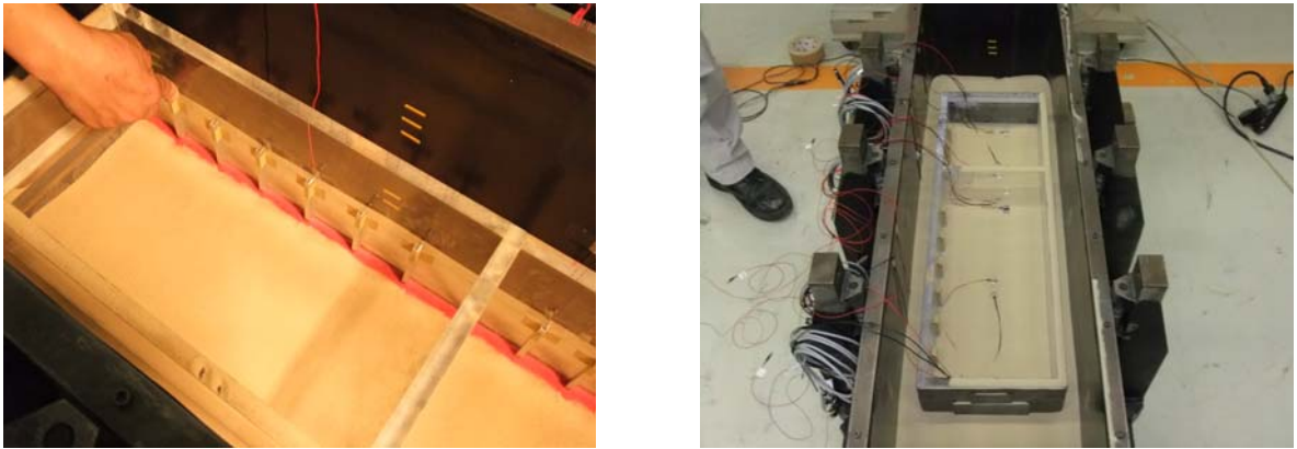
図 4.3-2 色砂の設置(左)、地盤の作成状況(右)
