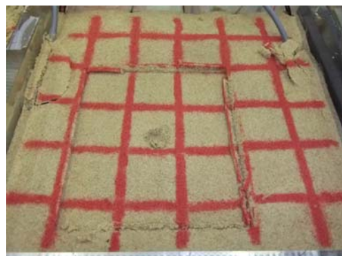
図 6.2-5 Case2 加振後の格子状地中壁側面と地表面の写真
