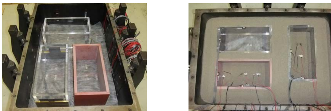
図 4.9-2 模型地盤の作成状況
