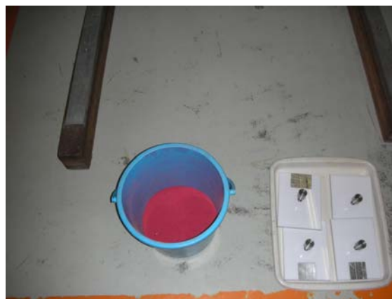
図 4.1-1 格子状中壁内部地盤の可視化に用いた色砂(赤色)と住宅模型(右)
