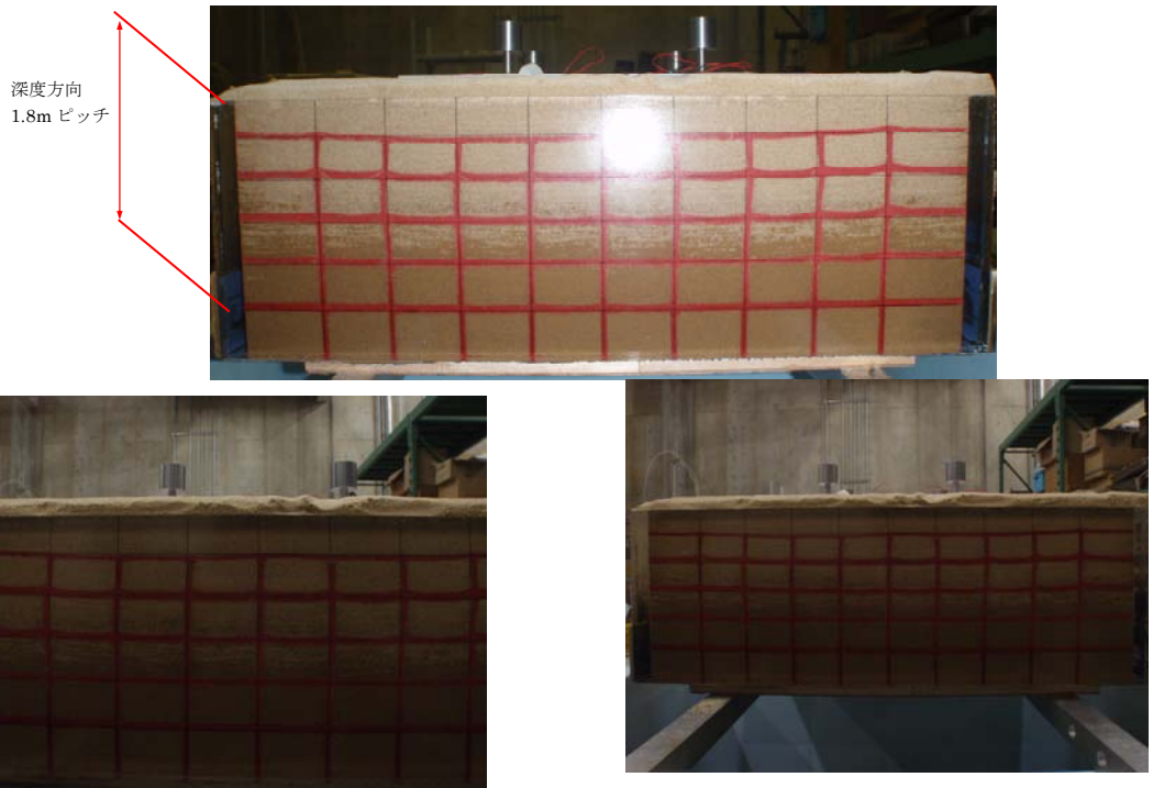
図 6.2-7 Case3 加振後の格子状地中壁側面の写真
