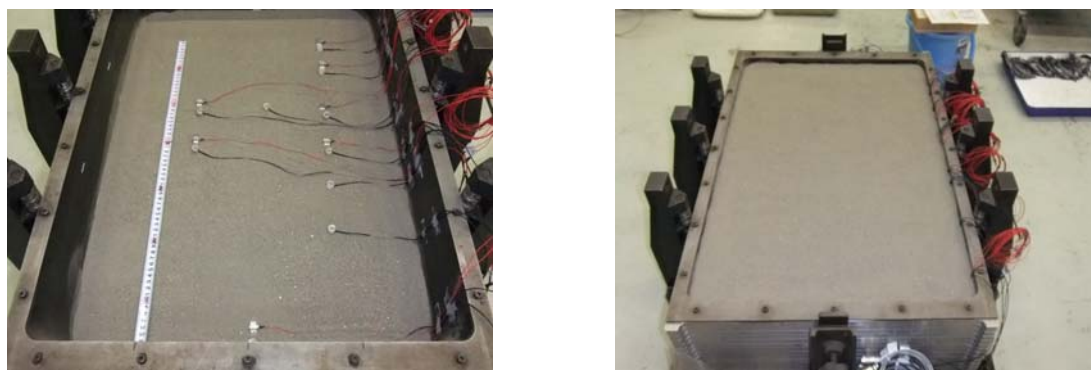
図 4.7-2 模型地盤の作成状況(左)、模型地盤の作成完了(右)
