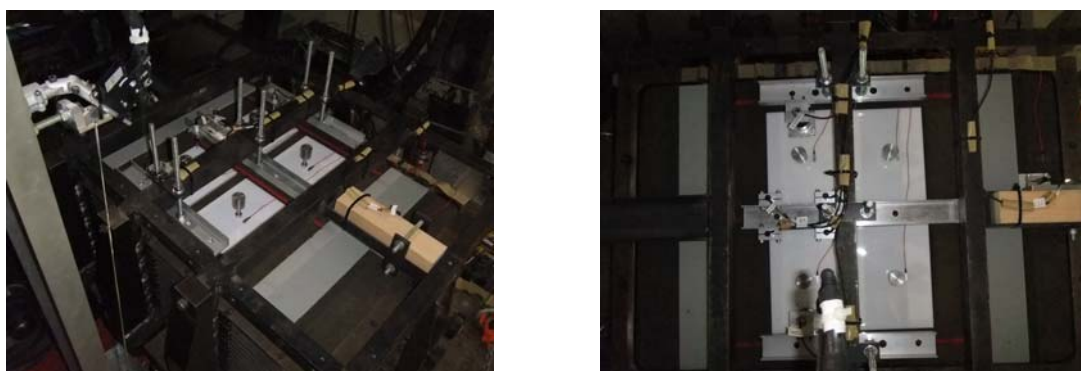
図 4.6-2 模型地盤の作成状況(左)、模型地盤作成完了(右)
