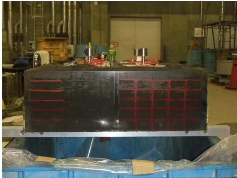
図 6.2-11 Case6 加振後の格子状地中壁側面の写真
