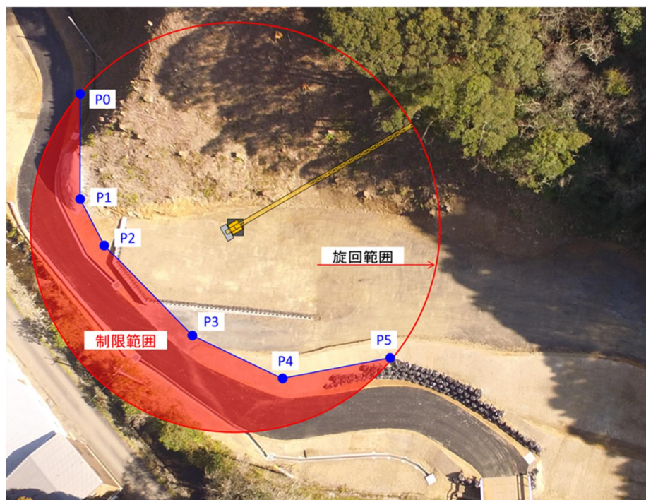
写真 2-1 水平ジブの旋回範囲内に制限範囲がある工事現場の例
