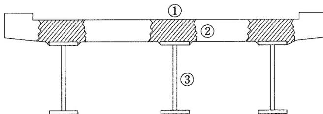
作業順は、①の斜線部を大型ブレーカで1次破碎後、鉄筋をガス切断、②のブロック塊をホイールクレーンで撤去し、③の桁材切断・撤去を行う。
