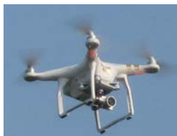
UAV(ドローン等)による3次元測量
