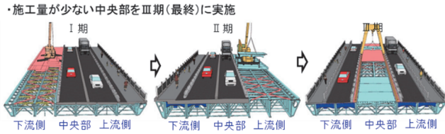
図-4 遅延リスクを低減する施工手順の採用
