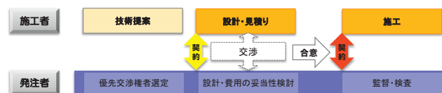
図-3 設計交渉・施工タイプのフロー
