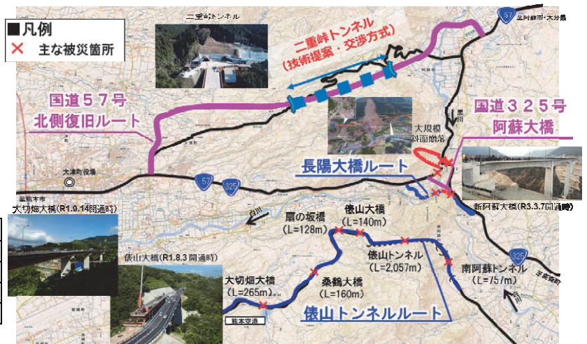
図-1 熊本地震における被災・復旧状況
