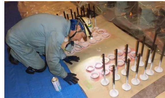
分解整備中 (吸・排気バルブ 浸透探傷検査※)
