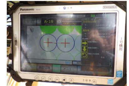
（従来）誘導員による位置決め （ICT）施工位置のガイダンス画面（例）
