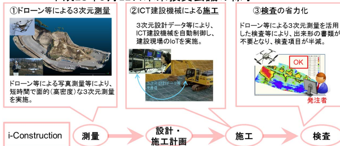
ICTの土工への活用イメージ (ICT土工)
