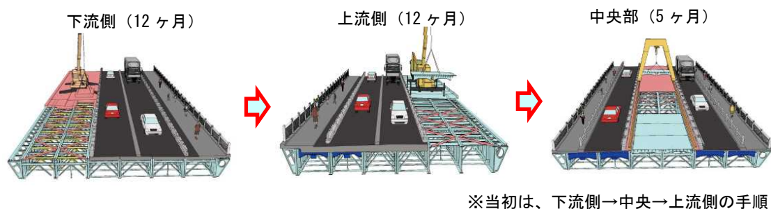
図-3-1 淀川大橋床版取替の施工手順
