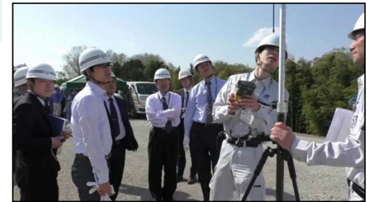
GNSSローバーでの実地検査イメージ
