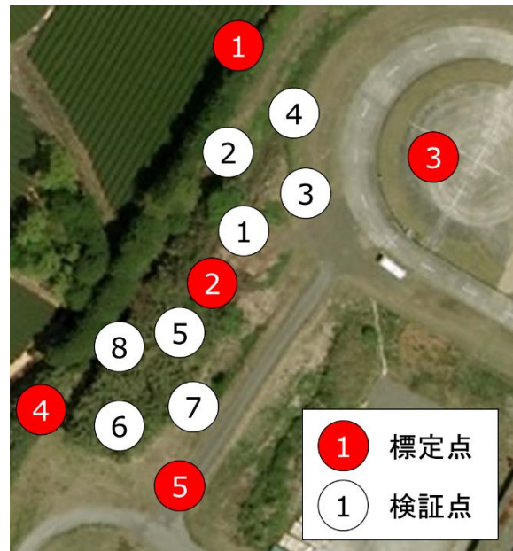
図-3 標定点と検証点の配置
