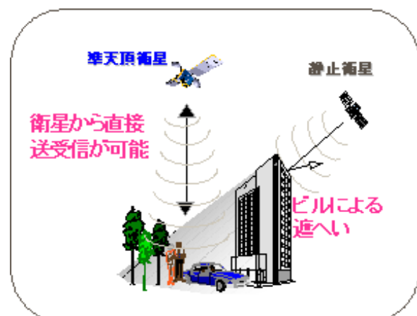
図-1 準天頂衛星の概要
