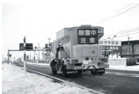
写真-1 凍結抑制剤散布車による作業状況
