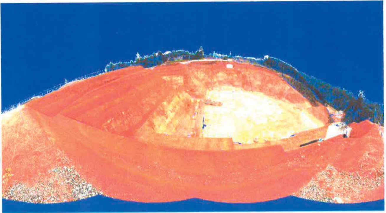
図-3 測量結果の3次元モデル
