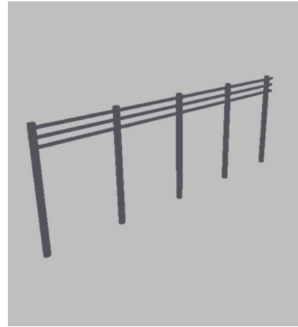
(ガードレール (三連パイプ))
