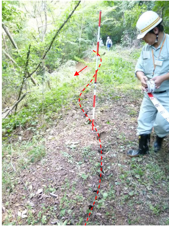
谷側の崩壊地と亀裂
