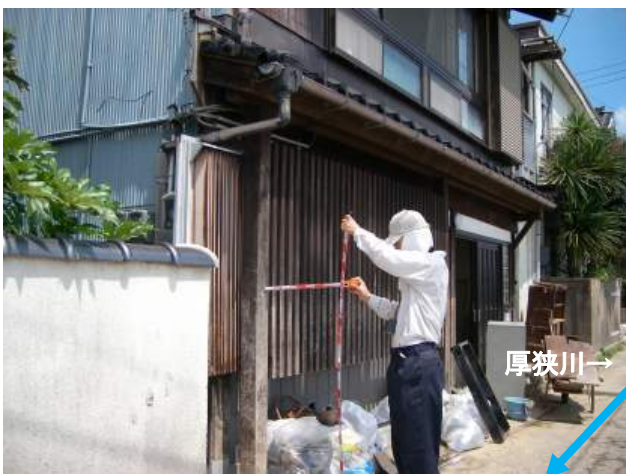
写真7 右岸旧街道鴨橋付近(浸水痕跡 約1.3m)
